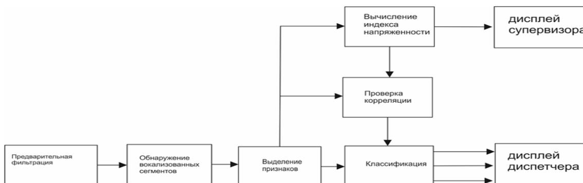
Рис. 3. Обобщенная схема двухуровневой системы мониторинга речи
